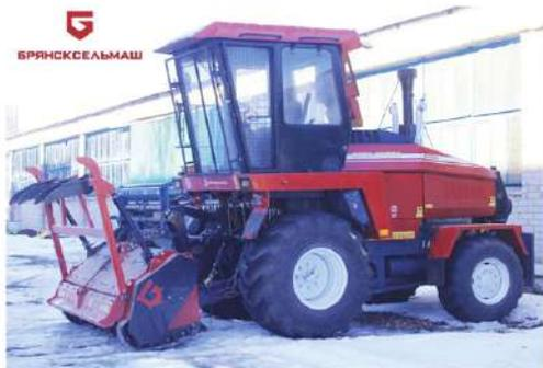
Глубина обрабатываемой почвы, не более, мм — 30.
